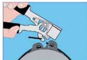
4. Überschüssiges Band abschneiden
