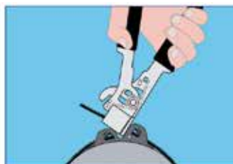
3. Das Band mit dem Werkzeug straffen
